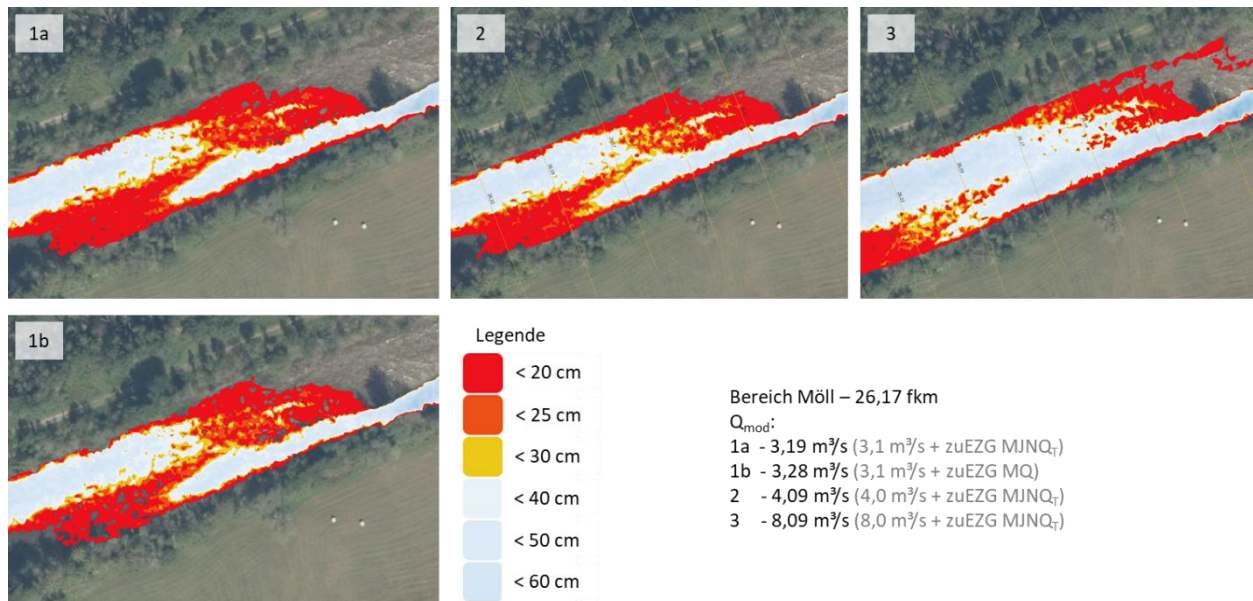
Abbildung 71: Wassertiefenverteilung in einem pessimalen Furtbereich der Möll bei Flattach bei Flusskilometer 26,17 für unterschiedliche Abflüsse (die Darstellung zeigt die Wassertiefen farblich abgestuft: Tiefen unter 20 cm in Rot, unter 25 cm in Orange, unter 30 cm in Gelb sowie Tiefen ab 30 cm in abgestuften Blautönen).
