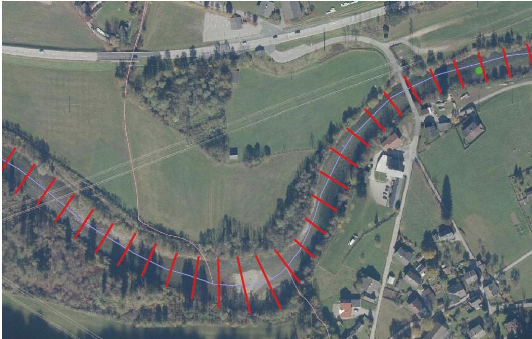
Abbildung 37: Beispielhafter Gewässerausschnitt der Möll im Bereich der Pegelstelle Flattach mit anhand von GIS-Analysen bestimmten Gewässerbreiten (rot, grüner Punkt: Pegelstelle 213124, Flattach)
