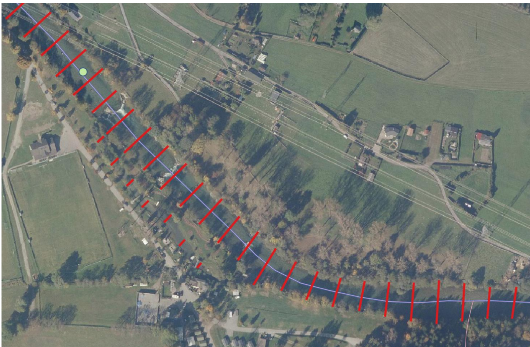
Abbildung 38: Beispielhafter Gewässerausschnitt der Möll im Bereich der Sonde Obervellach mit anhand von GIS-Analysen bestimmten Gewässerbreiten (rot, grüner Punkt: Sonde 301017, Obervellach)
